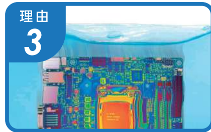
新開発の液体冷却システム
