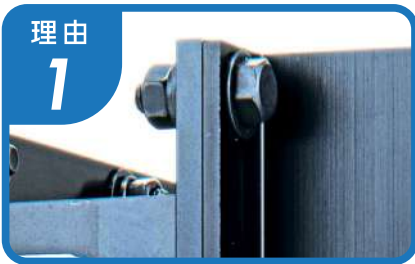
超高気密な真空フランジ構造
